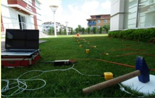
Il sismografo DoReMi è uno strumento innovativo che distribuisce lungo il cavo di stendimento l'elettronica necessaria alla registrazione del segnale sismico.
